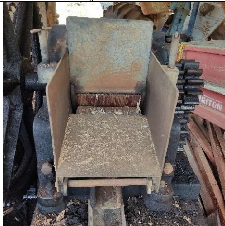
Foto 6: Detalhe da Moenda metálica do Engenho da Família Pimentel. Alex Alves Pereira, 18 jul. 2025.
